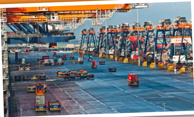
AGV's op de Euromax terminal. Iedere AGV heeft een nummer.
