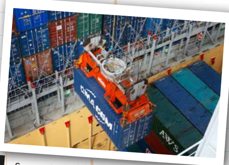
2 Spreader pakt de container op.
