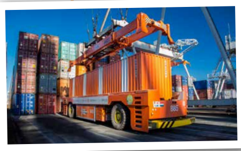
3 Container wordt op een AGV gezet.
